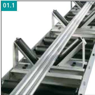
Schrägrollen zur Bündelspannung für RS 400 (Option)
