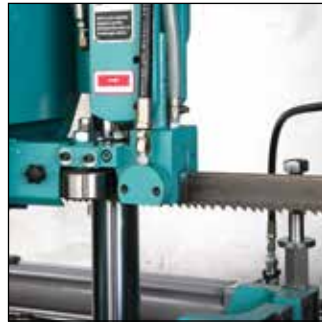
Hydraulische Bandklemmung ab SBS 330
