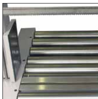
Angetriebene Rollen bei HA zur Feinpositionierung des Materials
