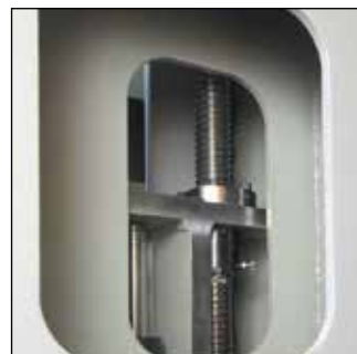
Sägerahmenvorschub über Kugelrollspindel
