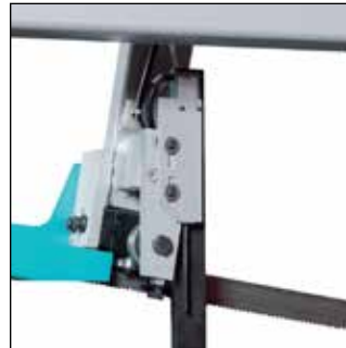
Autom. Sägebandführung zum Material
