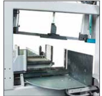
Zufuhrspannstock beidseitig öffnen
