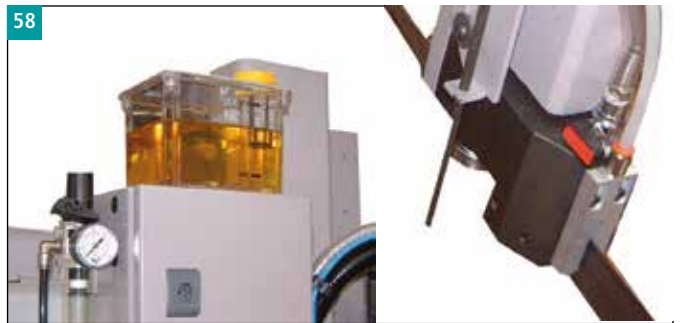
COOLMATIC PLUS Mikroprüheinrichtung
