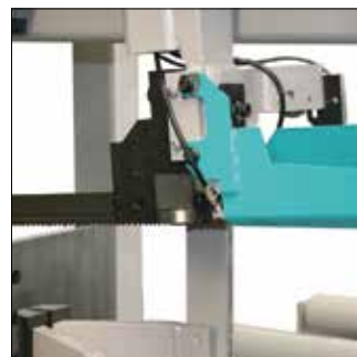
Hartmetall-Sägebandführung mit autom. Verstellung zum Material
