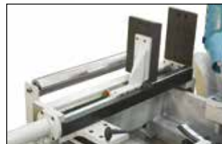
Spannstock mit Langhubzylinder
