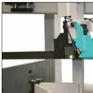
Autom. Sägebandführung zum Material
